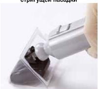
Переключите выключатель клиппера в положение выключено. Держите корпус клиппера под углом 45° над открытой упаковкой со сменной насадкой. Вставьте корпус в крепление до щелчка. Перед удалением сменной насадки выключите клиппер и надавите на нее для отсоединения.
